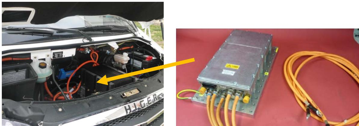
3.2.2 作用：根据整车控制器的要求，和驱动电力的信号反馈，控制驱动电机的转向、转速、转矩。
