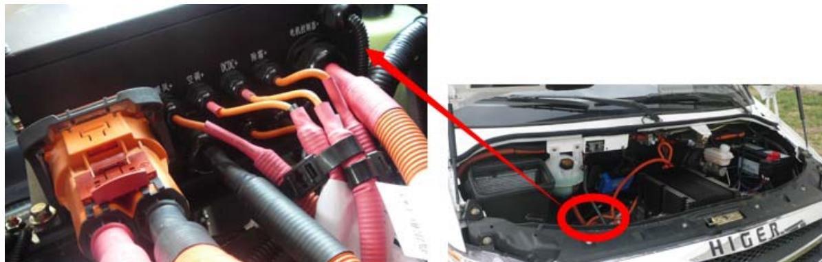
3.5.2 作用：连接动力电池，将动力电分配给动力电用电器，如驱动电机控制器、DC/DC、空调电压缩机、除霜 PTC、暖风 PTC。并对除霜 PTC、暖风 PTC 的供电状态进行控制。
